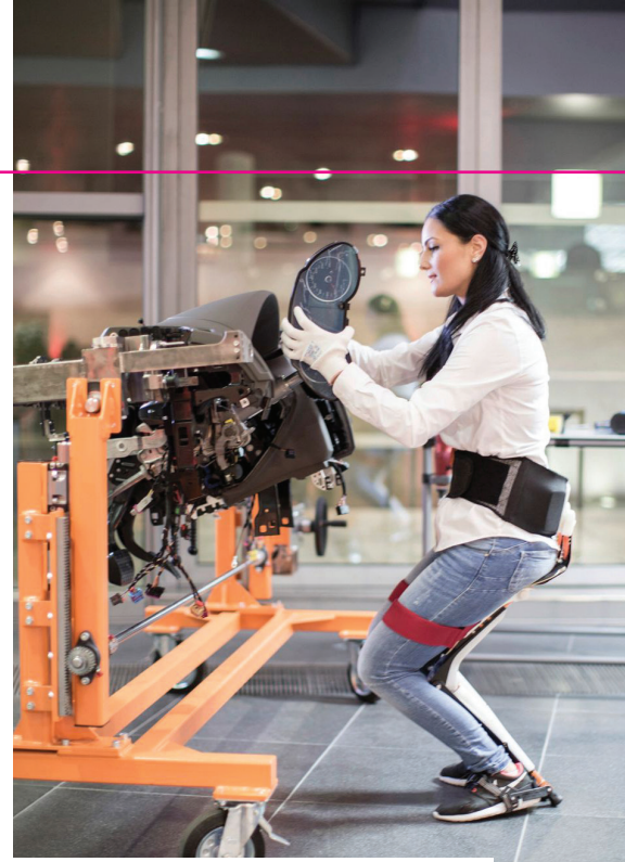
Otomotiv sektörü Fabrikalarda işçilerin sahada oturup dinlenmesi için yer yok. Audi'nin dış iskeletleri resimdeki tehlikeli pozisyonlarda bile sakatlanmayı önleyerek dinlenmeyi sağlıyor.
